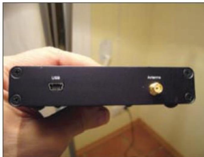
Foto B. En el panel trasero del AirNav RadarBox se encuentran un conector USB miniatura para su conexión al PC y un conector SMA para el cable de la antena.
